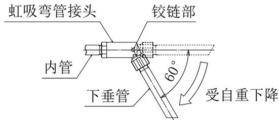
2. 请将产品旋转至下垂管与内管成一直线，插入滚筒中。
