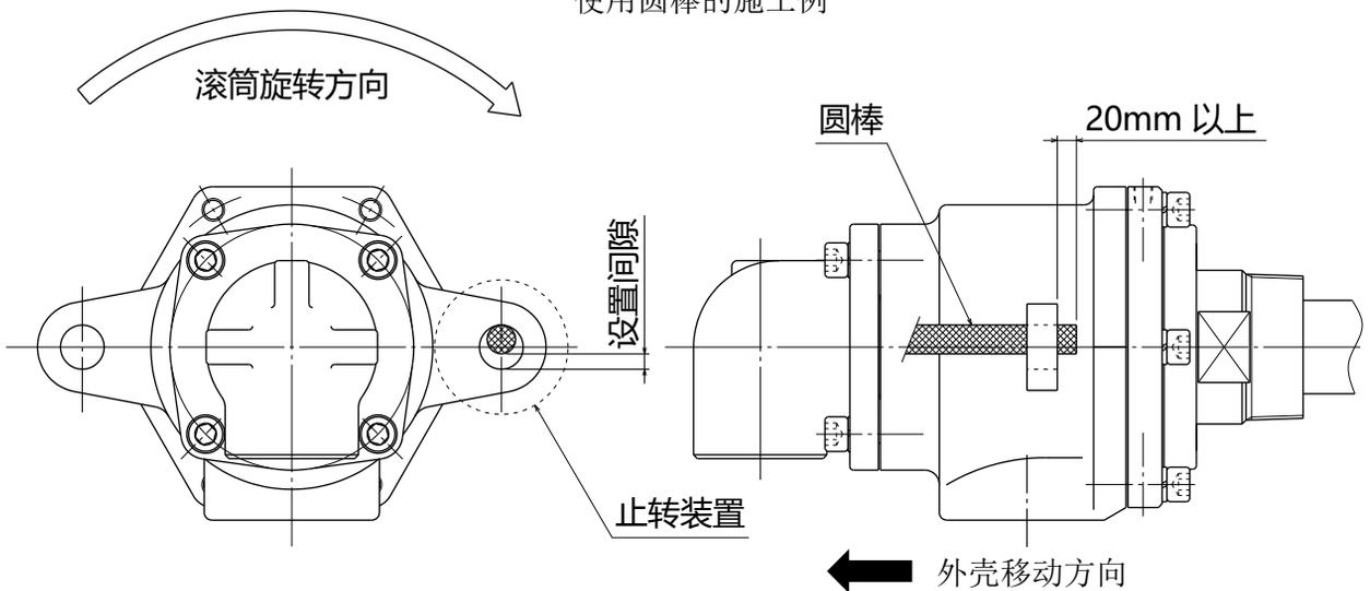
注释 ) 随着运转时间的推移，密封圈的密封面会发生磨耗，外壳向箭头方向移动。
